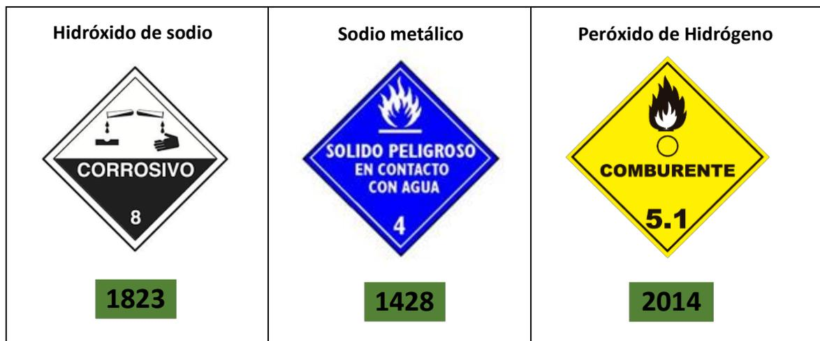
Figura 12 Ejemplo de identificación de la sustancia peligrosa de acuerdo con el UN.
