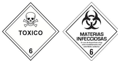
Figura 6 Etiquetado o rotulado que establece la NCh.382 para la Clase 6.
