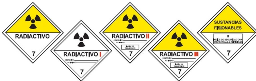
Figura 7 Etiquetado o rotulado que establece la NCh.382 para la Clase 7.
