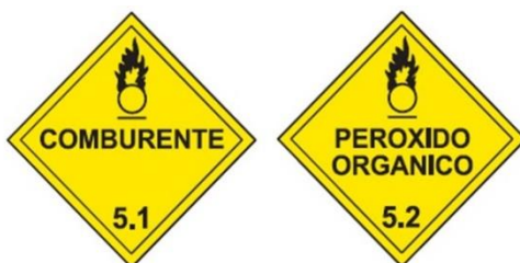
Figura 5 Etiquetado o rotulado que establece la NCh.382 para la Clase 5.
