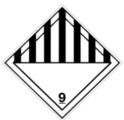
Figura 9 Etiquetado o rotulado que establece la NCh.382 para la Clase 9.
